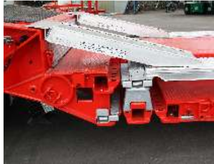
Anlegerampen zum Befahren des Schwanenhalses
