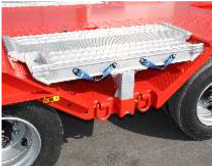
Radmulden zwischen 2. und 3. Achse mit ALU-Abdeckungen
