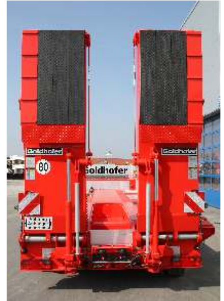
2-teilige Rampen mit „superGrip“ Gummibodenbelag, Kletterleisten in Aussenfeldern sowie hydraulischer Rampenverschiebung
