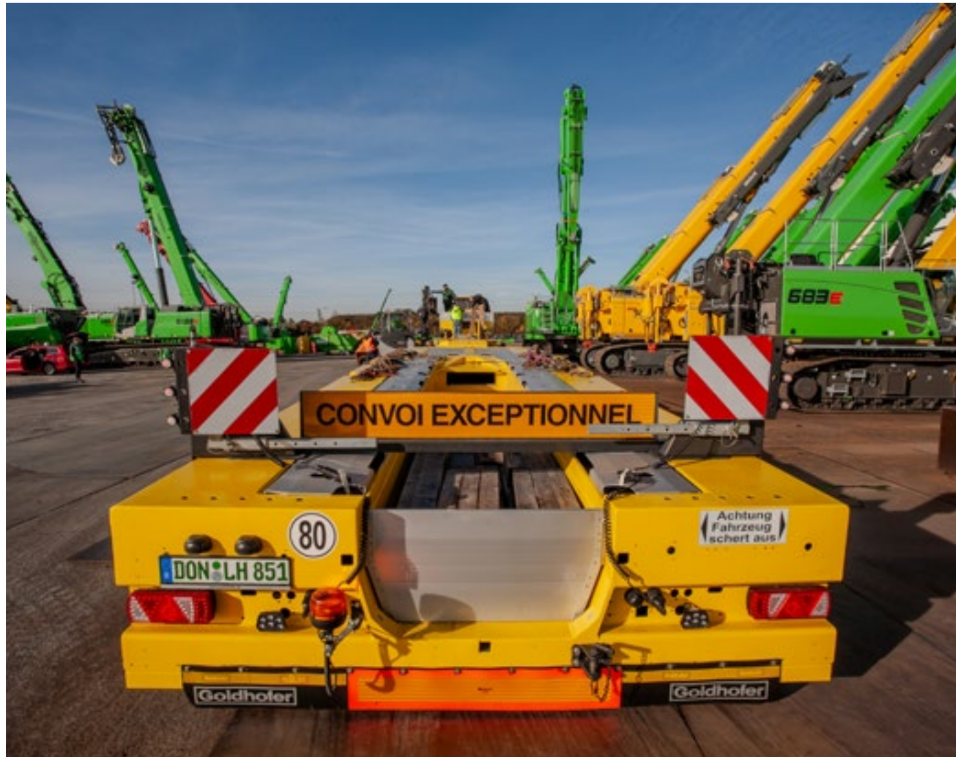
Mit einer besonders breiten Baggerstiellmulde können auch größte Baumaschinen problemlos transportiert werden.
