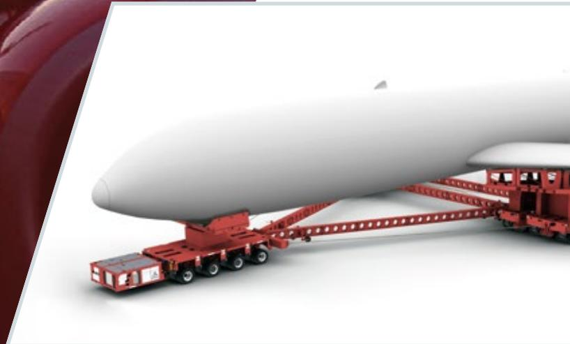
**Wir empfehlen das komplette Bergesystem. Warum? Es ermöglicht Ihnen auf jeden Zwischenfall auf der Start- und Landebahn vorbereitet zu sein. Bestehend aus einem vorderen Modul und zwei Wing-Support-Modulen, ermöglicht es die schnelle und sichere Bergung, selbst wenn alle Fahrwerke beschädigt sind.**
