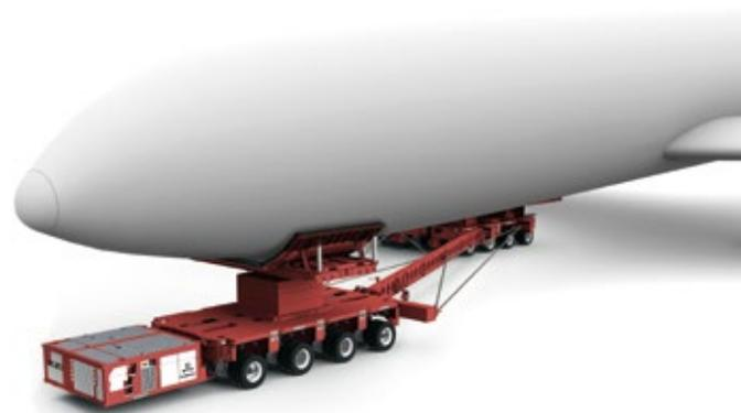
**Die Risikoabdeckung wird durch die Ergänzung eines Wing-Support Moduls zum Hauptmodul der professionellen oder Premium-Lösung erweitert. Dieses System erlaubt die Bergung von Flugzeugen, bei denen nicht nur das Bugfahrwerk, sondern auch eines der Hauptfahrwerke beschädigt ist.**
