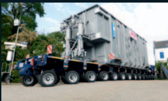
Der Transformator wird zur NATO-Rampe gefahren. Immer wieder konnte mithilfe des 280PS starken PowerPacks nachgelenkt und das Niveau ausgeglichen werden.
