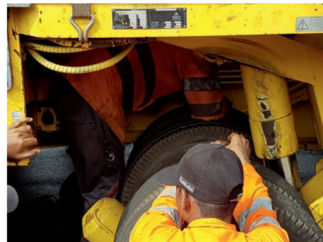
Reifenwechsel kein Problem: Der hydraulische Achsausgleich ermöglichte ein einfaches Wechseln auch der inneren Reifen
